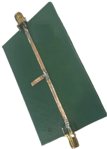
Рисунок 2 – Макет платы со шлейфом холостого хода и его характеристики
