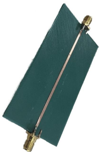
Рисунок 1 – Макетная плата с микрополосковой линией и её характеристики
